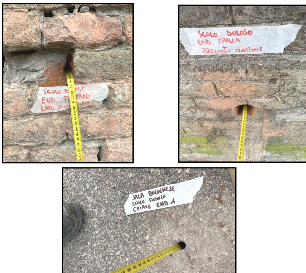
Figura 8 – Endoscopie eseguite.
