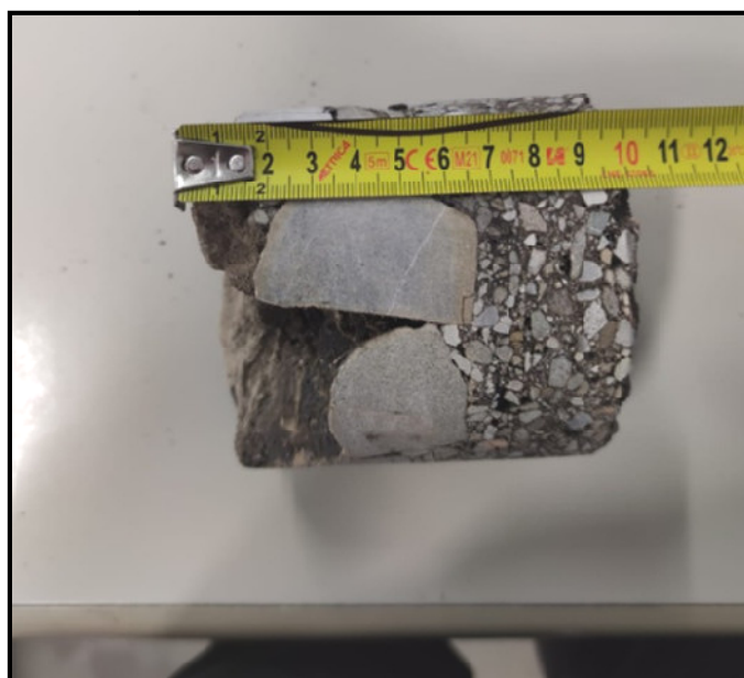
Figura 6 – Misura dello spessore della carota in conglomerato bituminoso.
