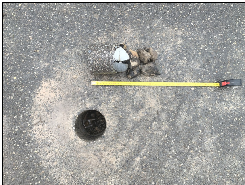
Figura 3 – Prelievo carota conglomerato bituminoso.
