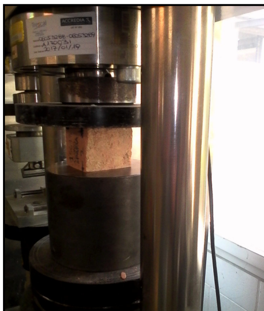
Figura 13 – Prova di compressione su laterizio.
