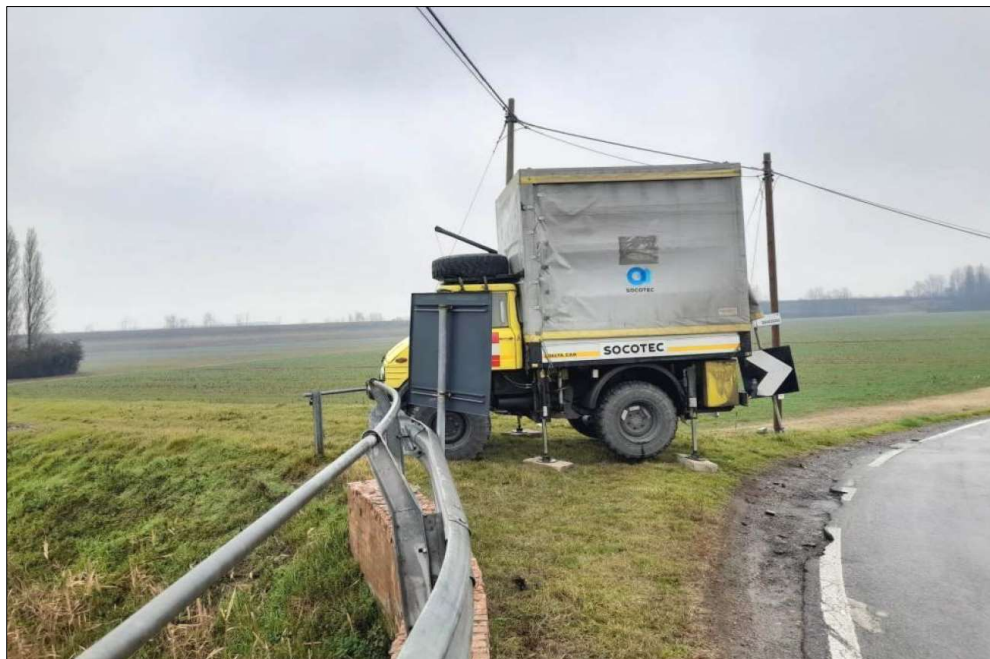
Figura 8.3 Particolari della realizzazione dell'indagine penetrometrica statica CPTU1
