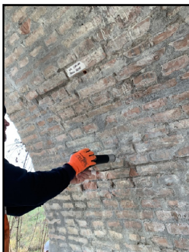
Figura 12 – Esecuzione di indagine penetrometrica.
