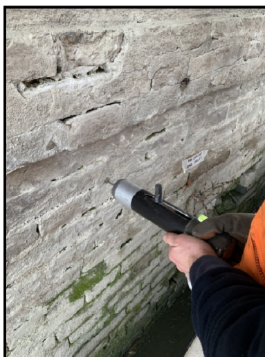
Figura 11 – Esecuzione di indagine penetrometrica.
