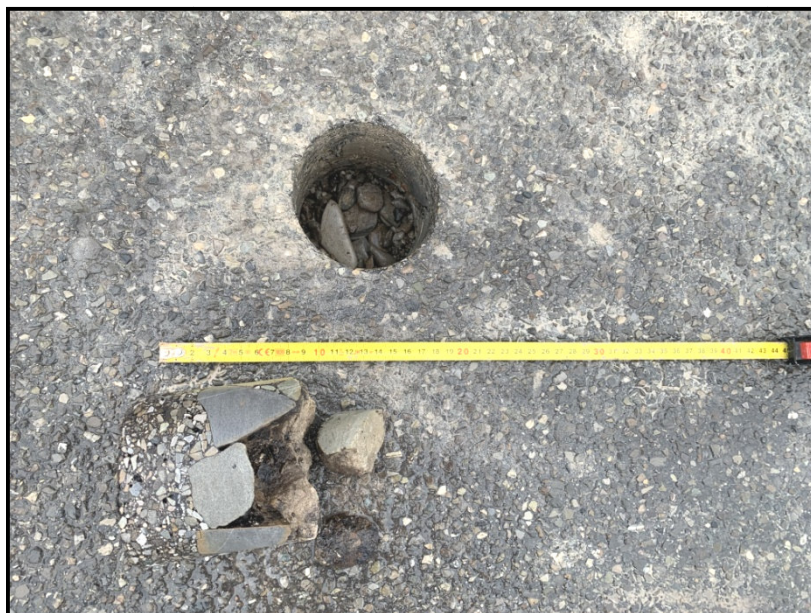
Figura 5 – Prelievo carota conglomerato bituminoso.
