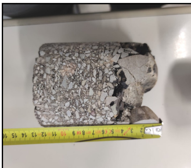
Figura4 – Misura dello spessore della carota in conglomerato bituminoso.
